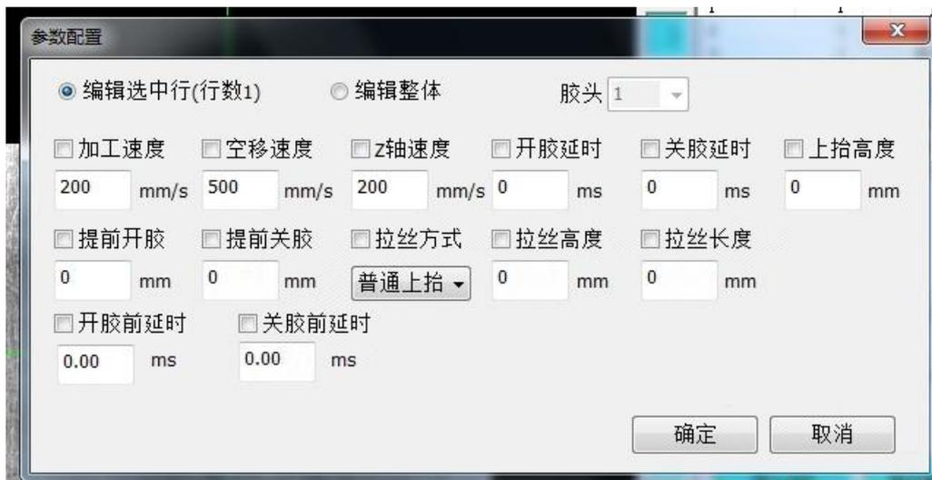
**工艺参数：**编程坐标区右下方有一个工艺参数显示，只需要在编程坐标区中单击左键选中一个节点，右下角就会显示该点的工艺参数。有某些节点不具备的工艺参数项，该区域则显示灰化。每个工艺参数的详细含义将在后面章节的“默认参数”模块中进行讲解。
