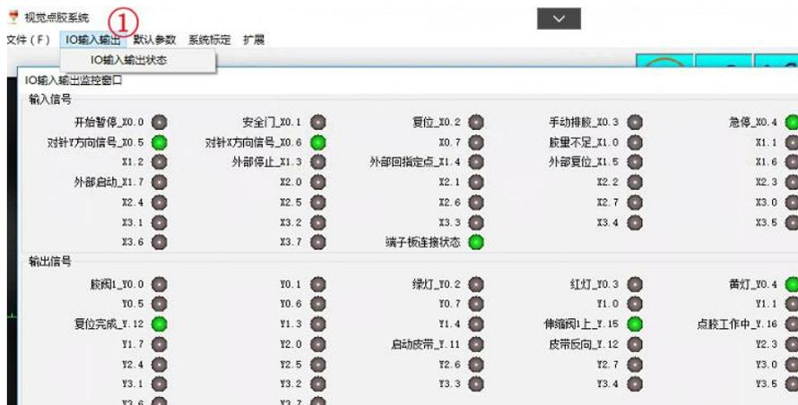
②点击开始自动对针——③点击是——观察 IO 输入输出监控窗口的对针 X 信号和对针 Y 信号是否出现灰色
