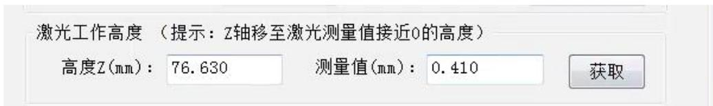
3、接下来进行模板学习、路径设置和阵列设置，模板学习、路径设置和阵列请参考 [2.2.1 模板学习](#) 到 [2.2.6 阵列功能](#)，制作完成后点击设置轨迹中的测高点设置，在弹窗中选择示教当前位置为激光测高点，点击弹窗中的确认即可，继续进行 [2.2.8 生成加工文件](#) 直至文件制作完成，文件制作完成后点击开始加工即可。
