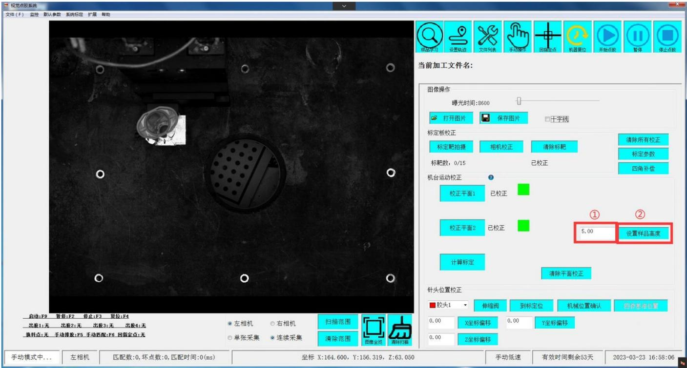
4、将针头移至设置好高度的工件平面上所选择的点上（所选的点位选择最好有明显特征）
