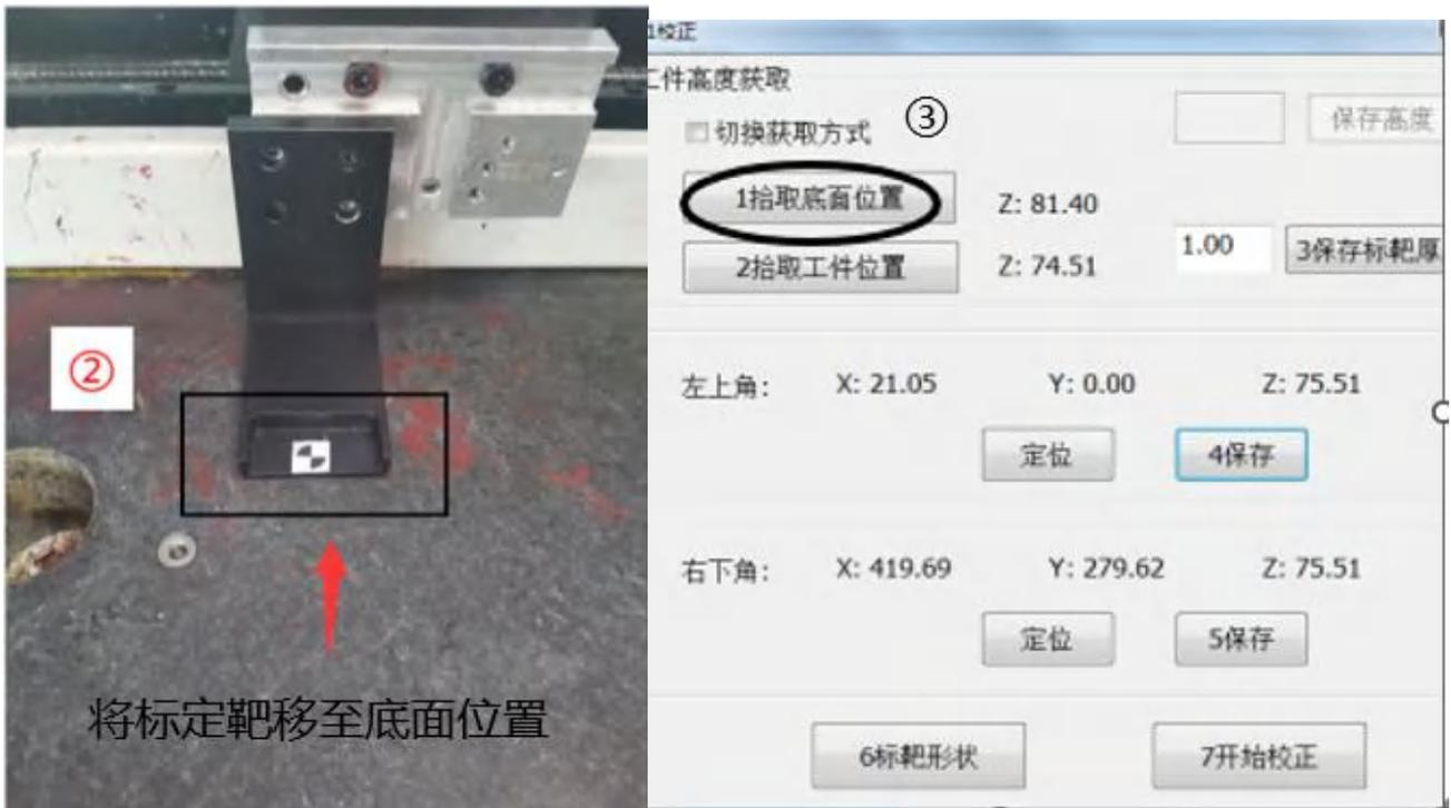
(3) 移动标靶至①工件上方位置压住工件后，点击②拾取工件位置，然后输入③标靶厚度数值后点击④保存标靶厚度（注意：拾取完高度后，接下来的操作中不能再移动Z轴坐标！）
