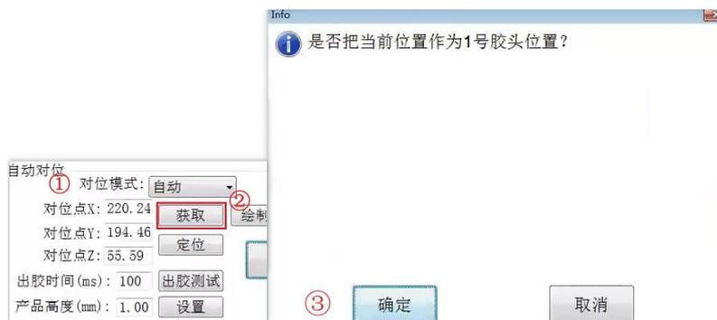
④输入出胶时间——⑤输入产品高度——⑥输入完成后点击设置，输入的参数才能生效
