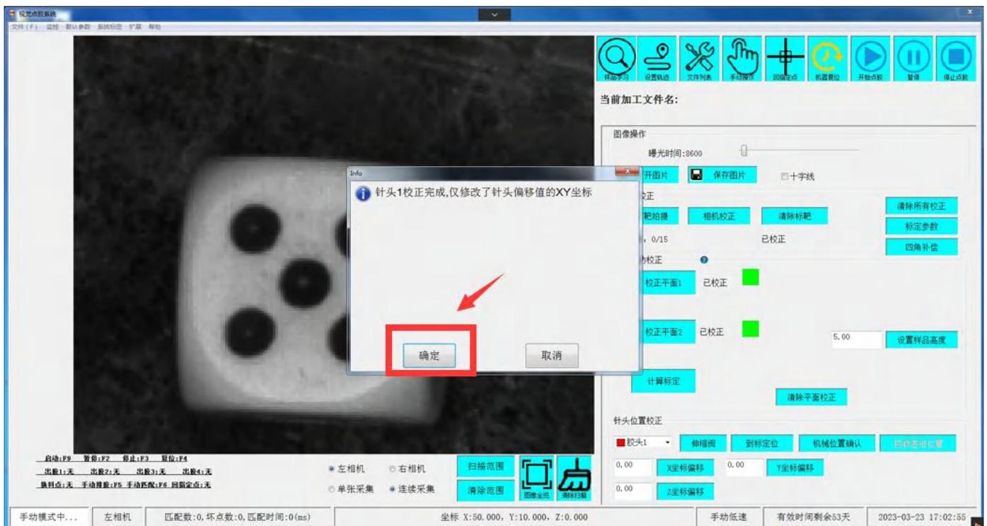
**注释：当开启对针是否同步 Z 坐标修改后，完成针头对位新建加工文件时，请勿再次对针，否则将造成已建加工文件 Z 轴坐标自行变化。**
