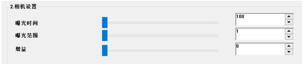
**曝光时间/范围：**调节图像亮度，如图像较暗就将曝光时间调大，太亮就将曝光时间调小，曝光范围是控制曝光时间的，2500 曝光时间等于 1%的曝光范围
