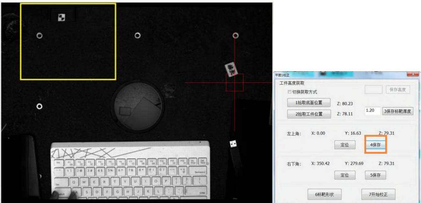
(5) 把平面标靶架移动到相机视野的右下角。单击保存右下角的坐标（如下图所示）。
