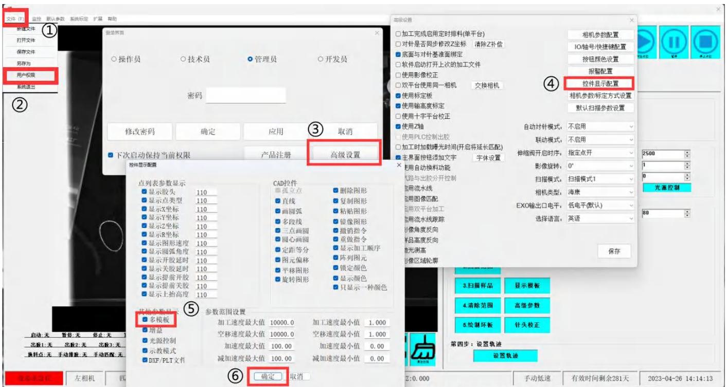
首先开启单文件多模板功能，打开①文件，②用户权限，③高级设置，④控件显示配置，确认⑤多模板是否勾选上了，勾选上后点击⑥确定，完成后关闭全部窗口回到样品匹配界面
