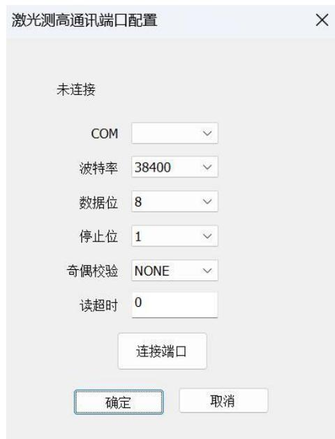
**COM：** 串行端口，设置为激光传感器接入口
